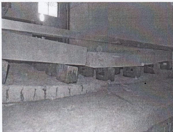
Фото 1 - 6. Образец сталебетонного перекрытия до, во время и после испытания.
